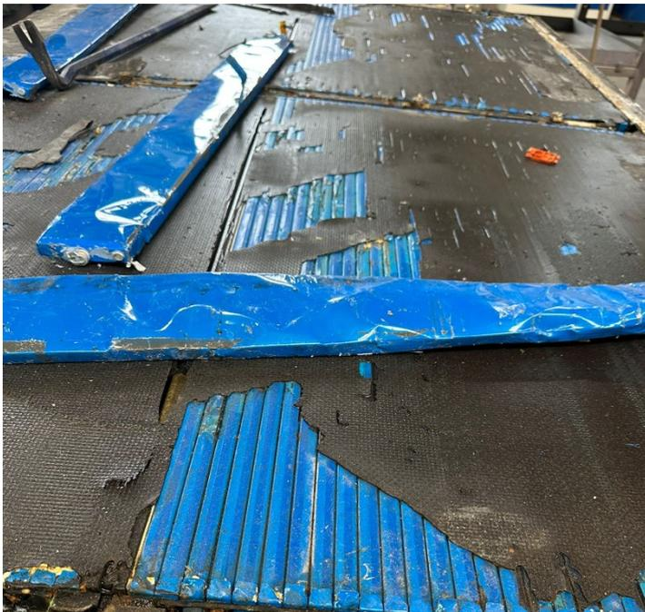
Photo d'une batterie CTL (BYD) en cours de démontage
