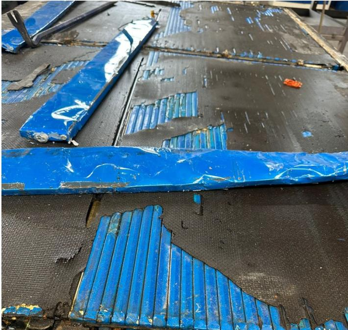
Bild einer CTL (BYD) Batterie bei der Zerlegung
