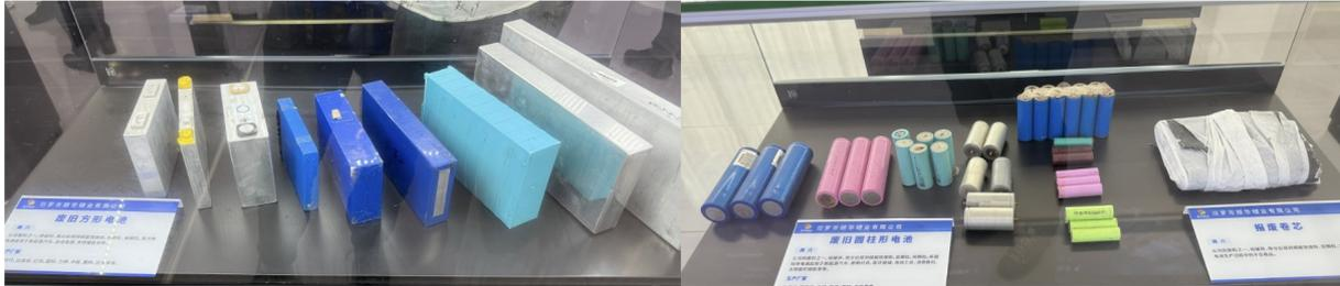
Typische Batteriezellen, links prismatische und rechts zylindrische resp. Pouchzellen
