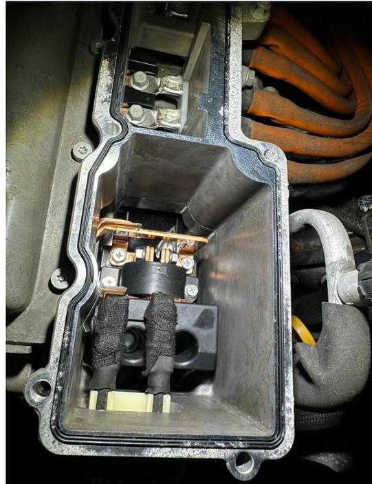
Weiterfahrt möglich – Die Kabelende wurden mit Schrumpfschlauch und Isolierband gesichert.
